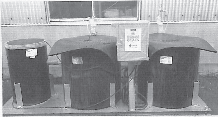
マイクロ・ナノバブルや特殊スポンジ内のバクテリアで排水を強力分解
